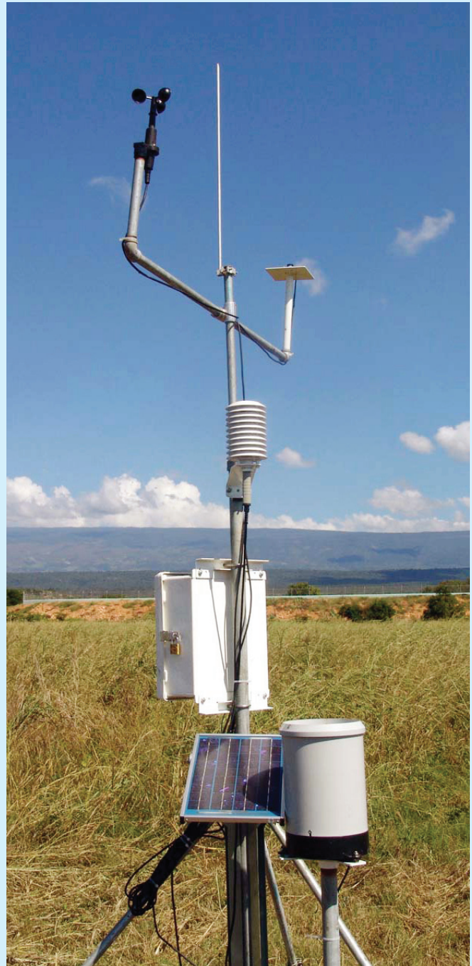
Estación climática instalada por el INDRHI en el Proyecto Olivares de Pedernales, dentro del programa de agricultura de precisión.
